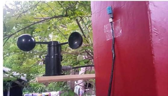
Figure 3: Anemometer and DHT11 Sensor
