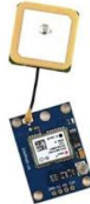
**Figure 3** GPS Module GY-GPS6MV2 [9].
