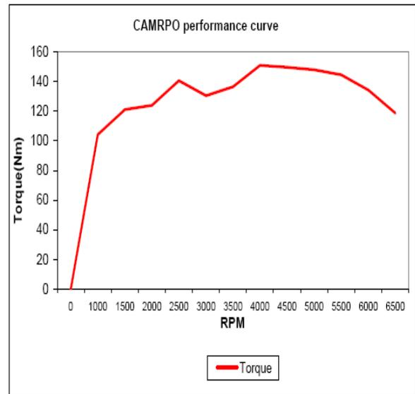
Fig. 6. CAMPRO Torque Curve
